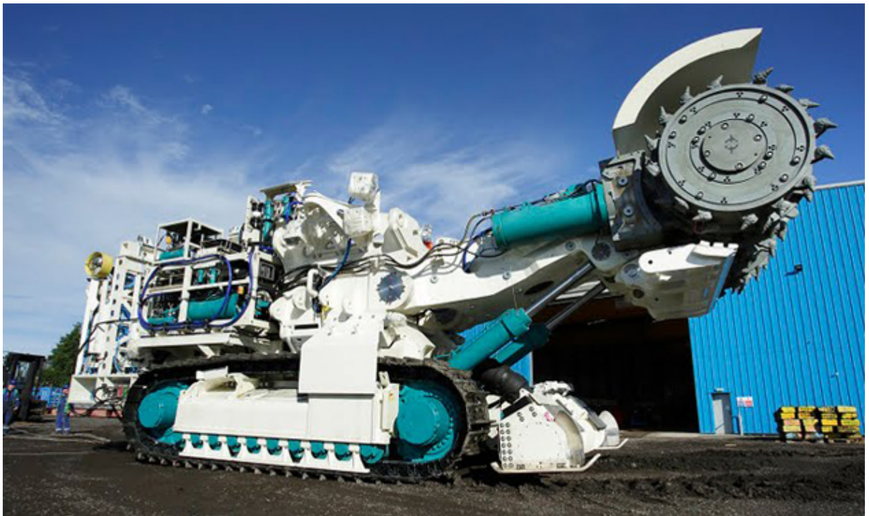
Eine von Nautilus Minerals entwickelte und auf den Einsatz am Meeresboden ausgelegte Produktionsmaschine für die Gewinnung von Edel- und Basismetallen (Quelle: Nautilus Minerals)
