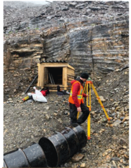
Abbildung 3 - 6400 Level LIDAR Untersuchung beim Eingang, beachten Sie die Definition der Portal-Basisstationsaufstellung
